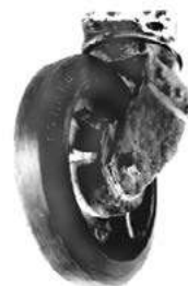
Banda de Vulkollan® Ha resistido perfectamente y conserva su perfil original.
