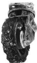
Banda de goma Completamente deteriorada, en la cual se han incrustado las virutas de acero.
