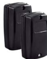
80-778 Emisor/receptor por infrarrojos. Alcance máximo: hasta 32 metros. Tecnología digital y microcontrolada. Inmune a ruidos. Base articulada para mejor alineación. Resistente a los agentes atmosféricos.
